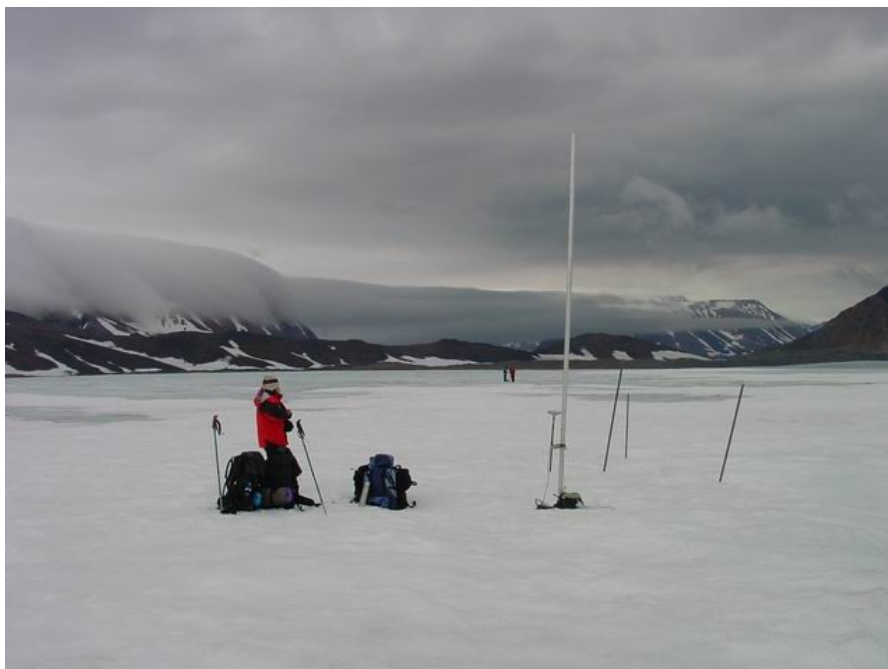
Rys. 3. Pomiar pozycji tyczek ablacyjnych na lodowcu Hansa (fot. A.Adamek)
