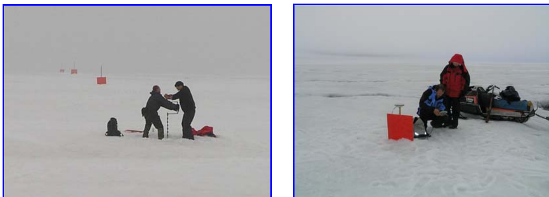
Rys. 2. Stabilizacja i pomiar znaków pomiarowych profilu poprzecznego
