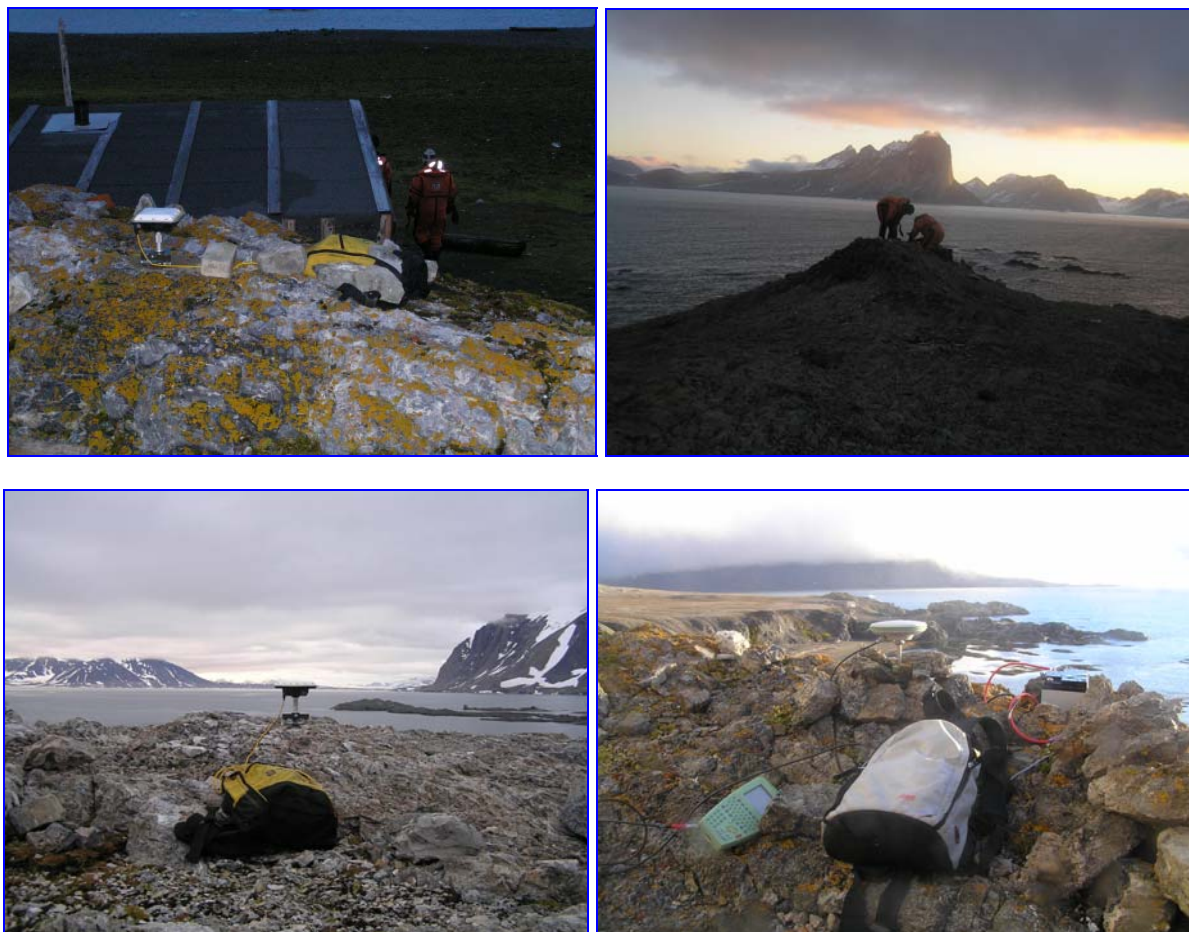
Rys. 9. Anteny satelitarne ustawione na punktach sieci geodynamicznej GNALODEN, FANYPYNTEN, HOFERPYNTEN, RASSTUPET (fot. autorów)
