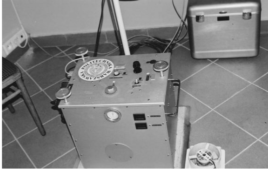
Rys. 6.1. Grawimetr sprężynowy LCR ET26
