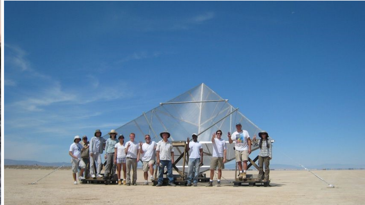
Pięciometrowy corner reflector w Rosamond Calibration Array (USA, Kalifornia) (źródło: https://uavsar.jpl.nasa.gov/cgi-bin/calibration.pl )
