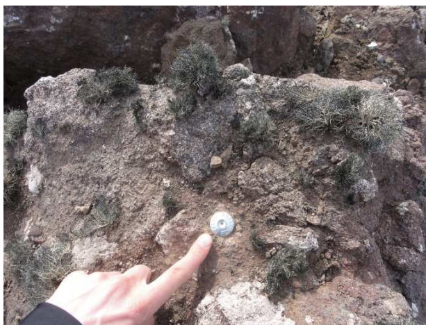
Rys. 1. Przykład stabilizacji ziemnej
