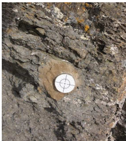
Rys. 2. Przykład stabilizacji ściennej
